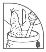
En 12 a 13 litros de agua agregue gradualmente un saco de 40 kg de Cemix Blanqueado Extrafino y mezcle hasta obtener una pasta suave y libre de grumos. Espere 10 minutos antes de usar la mezcla. Sin agregar más agua vuelva a mezclar para usar.
