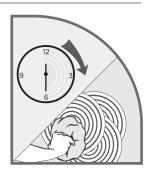
Aproximadamente 30 minutos después de la aplicación con una llana de duroport y con movimientos circulares dé el acabado floteado o el acabado deseado con llana metálica.
