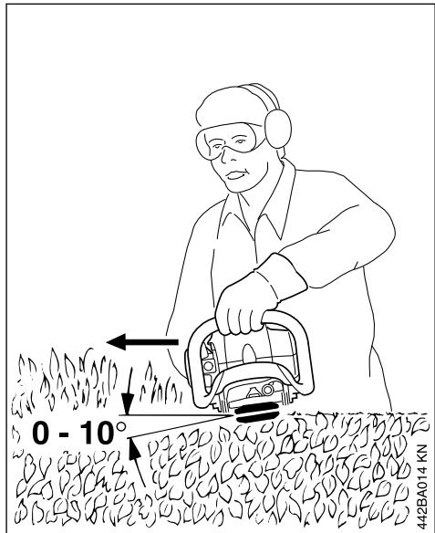
Colocar as lâminas de corte num ângulo de 0° a 10° – mas conduzi-las horizontalmente.
