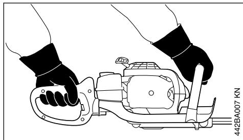
A mão esquerda no cabo de operação e a mão direita no cabo em forma de arco.
