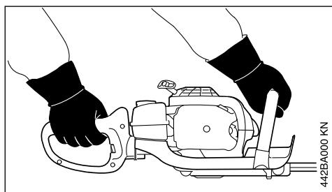
A mão direita no cabo de operação e a mão esquerda no cabo em forma de arco.
