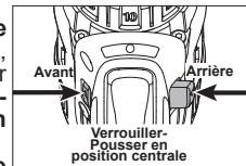
Pour une rotation **en marche arrière** (dans le sens anti-horaire), pousser le commutateur sur le côté gauche de l'outil. **Vérifier la direction de rotation avant utilisation.**
