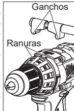
2. Para **retirar** el mango lateral, afloje su empuñadura hasta que pueda retirarlo. Cambie la posición y ajuste firmemente.
