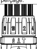
Bien réglé, l'embrayage réglable glisse à un couple préréglé pour éviter de visser trop profondément dans différents matériaux et pour éviter d'endommager la vis ou l'outil.
