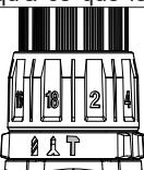
**N.B. :** Le chiffre sélectionné sur la bague de réglage du couple n'a aucun effet sur le fonctionnement de la perceuse tournevis en mode perçage.
