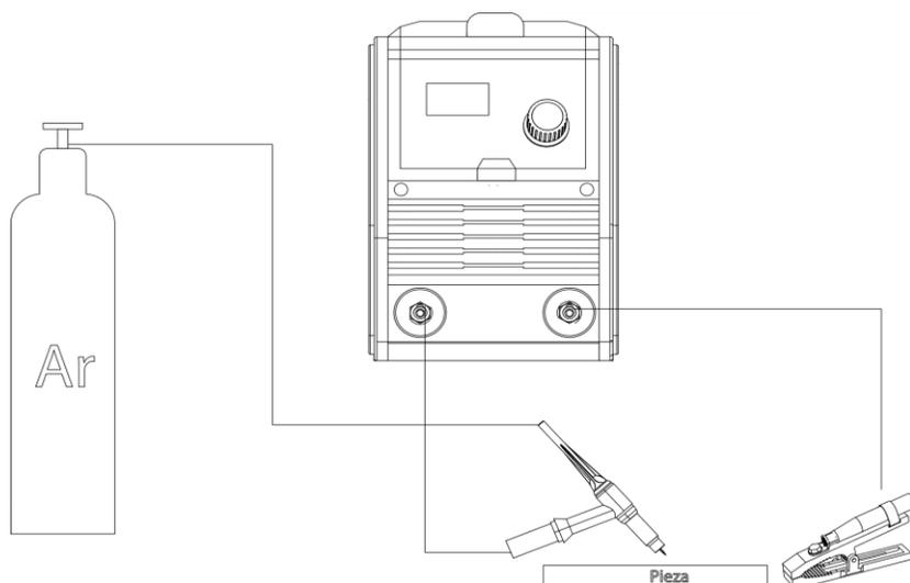
**EN TIG el gas debe estar conectado directamente a la antorcha y el inicio del arco se da por Lift Arc. El gas usado debe ser Argón o Helio, el cilindro debe tener un regulador de presión y se recomienda un flujo de gas de 16 a 20 l/m ó 32 a 40 CFH**
