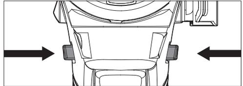
1. Para **avanzar** (el giro es en el sentido de las manecillas del reloj), se presiona el interruptor de control colocado al lado derecho del taladro. **Verificar la dirección del giro antes de usarlo.**
