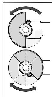
Coloque la cubierta protectora (6) sobre el cuello del husillo. Adapte la posición de la caperuza protectora (6) a las necesidades del paso de trabajo. Bloquee la cubierta protectora (6) apretando el tornillo de sujeción (5) con un destornillador para cabezas ranuradas en cruz.
