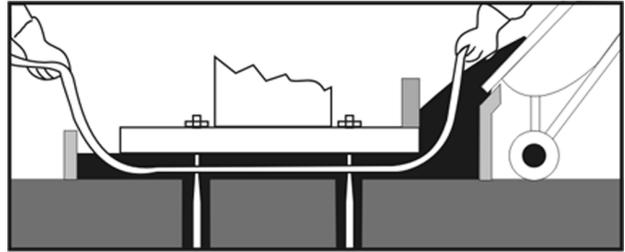
La mezcla debe colocarse continuamente y en el menor tiempo posible después del mezclado, ya que de acuerdo con las condiciones climáticas puede haber pérdida de fluidez si hay demoras en la colocación.
