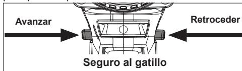
Para **avanzar** (el giro es en el sentido de las manecillas del reloj), se presiona el interruptor de control colocado al lado derecho del taladro. **Verificar la dirección del giro antes de usarlo.**
