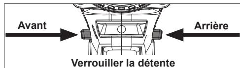
Pour une rotation **en marche avant** (dans le sens horaire), pousser le commutateur sur le côté droit de l'outil. **Vérifier la direction de rotation avant utilisation.**
