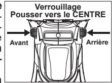
Toujours retirer la batterie avant d'effectuer un entretien ou de changer d'accessoire. Toujours verrouiller la détente ou retirer la batterie avant de remiser l'outil et toutes les fois que l'outil est inutilisé.
