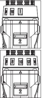
El embrague ajustable, cuando está bien ajustado, patinará al par de torsión preestablecido para impedir que el tornillo entre demasiado en diferentes materiales y para impedir dañar el tornillo o la herramienta.
